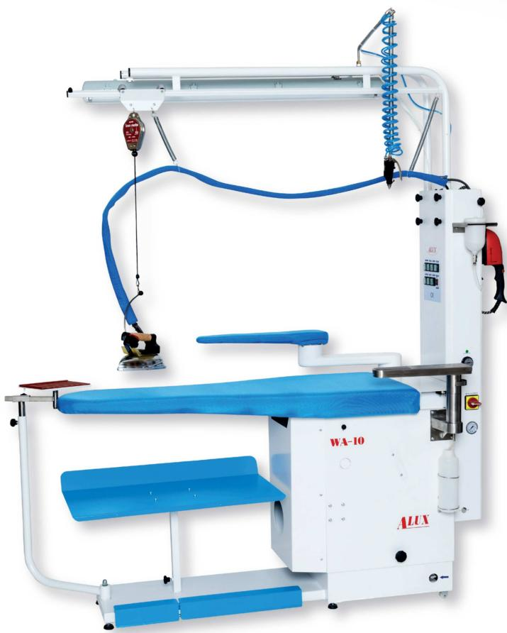
Stół prasowalniczy z wbudowaną wytwornicą pary, odsysaniem powietrza (WA-8, WA-8n) lub odsysaniem i nadmuchem (WA-10n), regulowaną temperaturą blatu i automatycznym przełączaniem odsysania na formę. W urządzeniu zastosowano pompę wirnikową oraz kocioł parowy wykonany ze stali kwasoodpornej. Produkowany jest również z regulacją wysokości blatu. Koty w urządzeniach firmy ALUX są wykonane ze stali kwasoodpornej.
